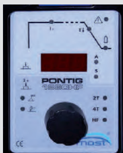
Панель PONTIG 1880 HF MOST - режимы работы
