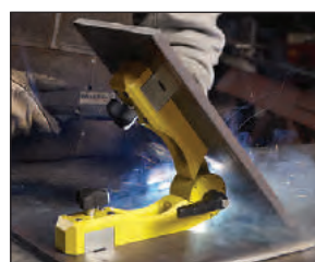
Два магнита держат с двух сторон
