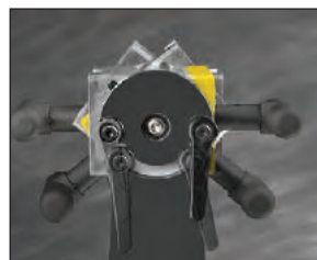
При поворотах зажима имеется возможность получить любой угол.
