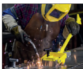
Установи устройство, включи магнит, нажми, чтобы выровнять. Сваривай. Просто и быстро.
