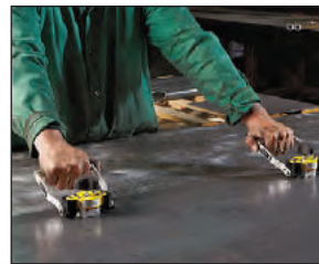
Двумя подъемниками можно переносить большие листы
