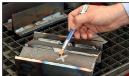
Маркировка исследуемого образца термоиндикатором (в данном случае 100°C)
