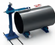
Выполнение продольных швов, возможность выполнения швов внутренних и внешних. Напр., при продукции контейнеров.
