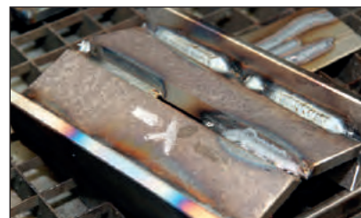
Обесцвечивание следа термоиндикатора после достижения заданной температуры
