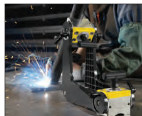
Хорошо держит плоские и овальные элементы. Идеально для соединения труб с плоскостями под любым углом.
