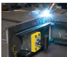
Поворот ручки на 180° прижимает зажим
