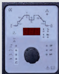
Панель PONTIG 2220 HF PRO MOST - режимы работы
