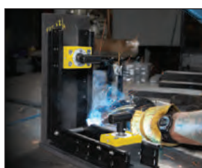
Зажимы можно переставлять и поворачивать в каждой оси
