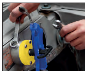
Держит шурупы, отвертки и всё что из металла в труднодоступных местах
