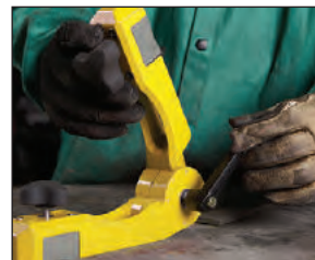
Эффективный замок, чтобы зафиксировать угол
