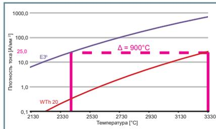
При одинаковой плотности тока, электроды E3® остаются приблизительно на 900°C холоднее, чем электроды WTh и, таким образом, имеют гораздо более высокую нагрузочную способность.
