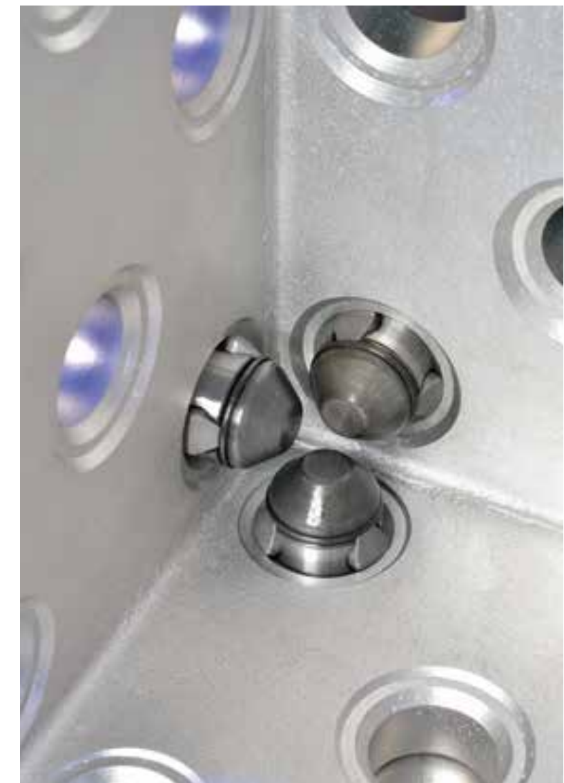
Сравнение шарового зажимного болта и нового полигонального болта компании Demmeler
